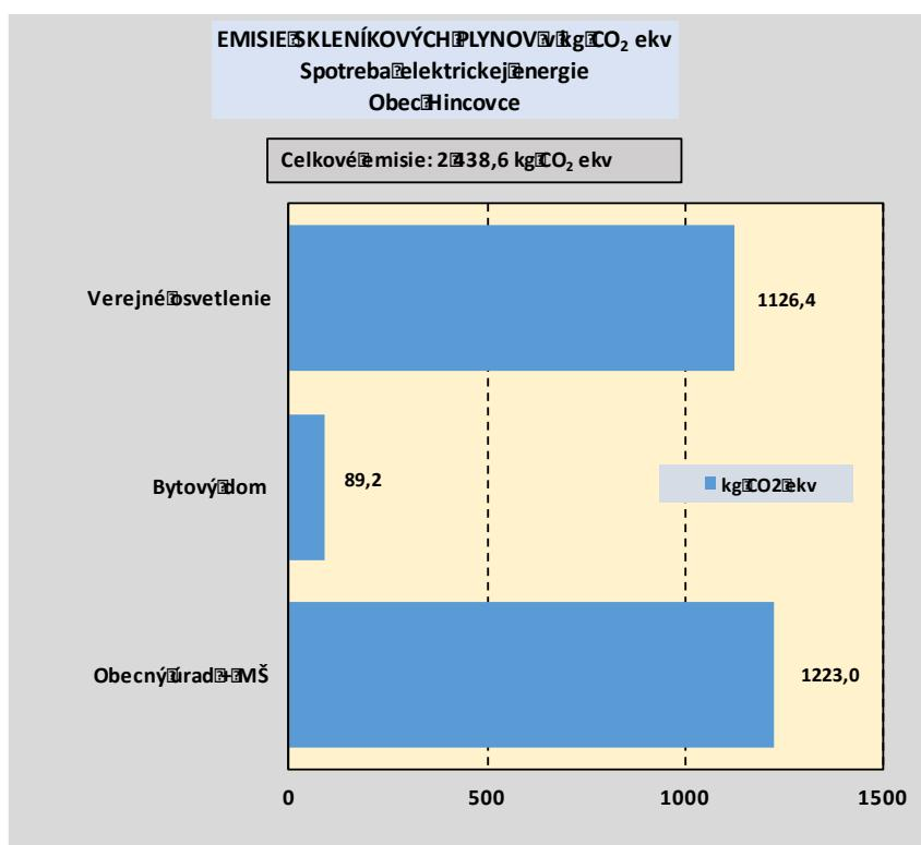
**Obr.2** Emisie oxidu uhličitého (v kg CO<sub>2</sub> ekv) zo spotreby elektrickej energie pre obecné budovy – obec Hincovce
